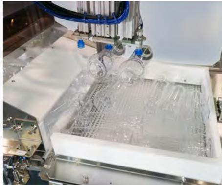
容器の向きを揃えてピッキングします。同様のボトル形状であれば、面倒なヘッドの治具替え無しに品種切替が出来ます。
