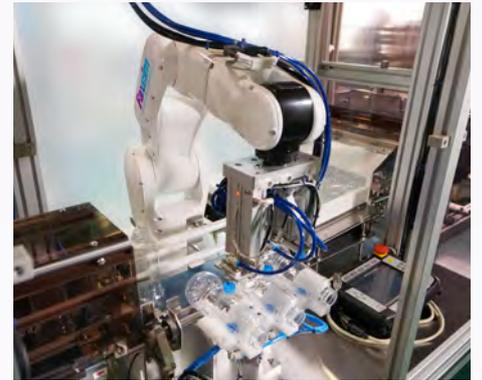
ロボットを使用する事により、複雑な動きが可能です。滑らかで、高速に容器を移載する事が出来ます。
